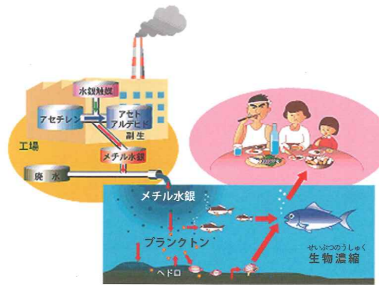
資料② 水俣病のあらし(メチル水銀が工場から人体に至る経緯) (環境省水俣病情報センター)
