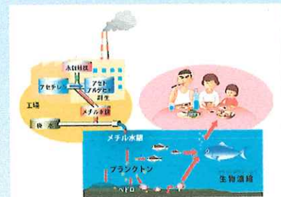
資料② 水俣病のあらまし(メチル水銀が工場から人体に至る経路) (環境省水俣病情報センター)
