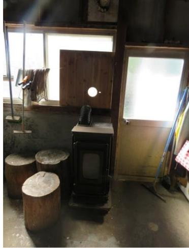
ストーブは、設置できたが、燃烧室内に竹炭を注入する装置により発生する粉炭が、横に寝かした状態の吸排気用煙突から、時々排出してしまい、改良が必要である事が分かった。吸排気を循環できるような仕組みを途中で配置する必要が出てきた。風呂用、室内暖房用の火鉢を使って、冬を過ごした。T シャツで過ごすようには温かくなれないが十分に室内を温めてくれる。2年間灯油の購入使用はせずに過ごしている。
